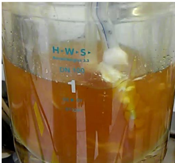
Figura 13 – Subproduto do processo de polimerização do ácido fenolsulfônico – ureia – formol.
